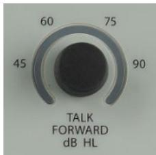
Este control giratorio permite al operador ajustar el nivel del micrófono en un rango continuo de 45 a 90 dB HL cuando se comunica a través de Talk Forward.
