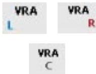
**Left, Center and Right VRA (VRA izquierdo, central y derecho):** se puede conectar un juguete derecho, izquierda o de centrado a AudioStar Pro. Los iconos VRA-L, VRA-R y VRA-C aparecerán en la pantalla cuando se hayan pulsado los botones el panel frontal para activar el sistema VRA.
