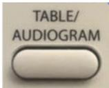
El botón Table/Audiogram se utiliza para seleccionar el formato de la visualización en pantalla. Al pulsarlo la pantalla cambiará entre mostrar la pantalla Table y la pantalla Audiogram para los tipos de prueba Tono, TEN y Habla. En el tipo de prueba Ton, este botón permite el acceso a la opción Resolución de frecuencia fina para pruebas de frecuencia detalladas.
