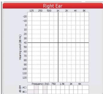
Al seleccionar el modo de visualización Audiogram, los datos audiométricos se muestra en formato gráfico. El usuario puede determinar la presentación de los gráficos de audiograma (Derecha/Izquierda, Izquierda/Derecha, o combinadas en un único gráfico). Mantenga pulsado el botón Test Type Tone (Tono de tipo de prueba) durante dos segundos para cambiar la vista de gráfico.
