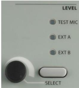
**Controles de nivel Test Mic, Input A e Input B:** para calibrar la señal de prueba del micrófono de prueba o los dispositivos externos, utilice el botón Select para activar el LED asociado con el dispositivo. A continuación, utilice el mango giratorio para ajustar el nivel de selección hasta obtener una indicación de 0 dB de media en el medidor VU del canal seleccionado.
