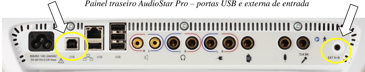
Painel traseiro Pello – portas USB e externa de entrada
