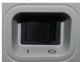
Przełącznik zasilania znajduje się na prawym panelu bocznym. Aby włączyć/wyłączyć audiometr GSI Pello, użyj przełącznika zasilania.
