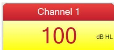
Audiometr Pello może emitować głośne dźwięki i jest zaprojektowany tak, aby osoba wykonująca badanie otrzymała wizualne wskazanie podczas prezentacji dźwięków o poziomie 100 dB lub wyższym. Wskaźnik poziomu jest wyświetlany z żółtym tłem, gdy do prezentacji wybrano dźwięk o wysokim natężeniu.
