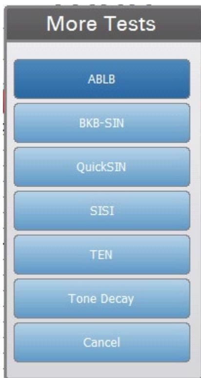
Stlačením tlačidla typu testu „Viac“ vyvoláte ponuku nižšie uvedených špeciálnych testov, ak máte nainštalovanú licenciu Special Test a/alebo Speech Plus: ABLB, BKB-SIN, QuickSIN, SISI, TEN a Tone Decay. Na výber špeciálneho testu použite navigačné tlačidlá alebo externú myš.
