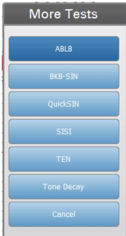
Premendo il pulsante "Altri tipi di test" è possibile aprire un menu contenente i seguenti test speciali, a patto che sia installata la licenza Test speciale e/o Speech Plus: ABLB, BKB-SIN, QuickSIN, SISI, TEN e decadimento del tono. Usare i pulsanti di navigazione integrati o un mouse esterno per selezionare il test speciale.
