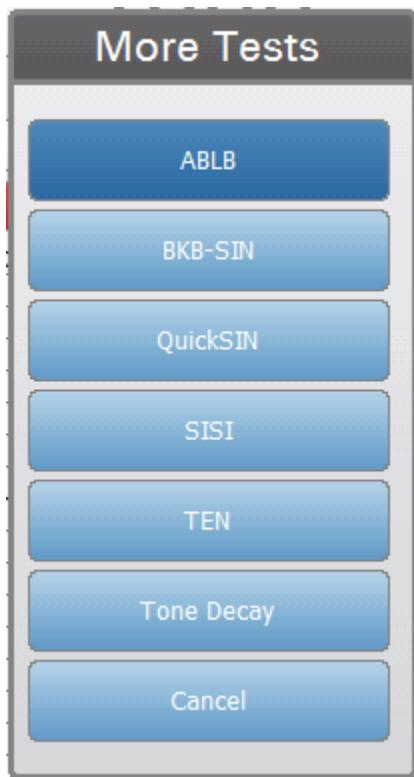
Knappen "Övriga testtyper" öppnar en meny med följande specialtester om licensen Special Test och/eller Speech Plus har installerats: ABLB, BKB-SIN, QuickSIN, SISI, TEN och Tone Decay. Använd de inbyggda navigeringsknapparna eller en extern mus för åtkomst till menyalternativen.
