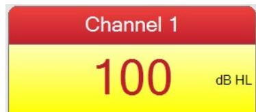
L'audiomètre Pello est capable d'émettre des sons forts et est conçu pour fournir un indicateur visuel à l'examinateur lorsqu'il présente des sons de 100 dB ou plus.
