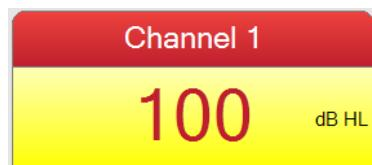
L'audiometro Pello è in grado di emettere suoni forti e fornisce all'esaminatore un indicatore visivo al momento di presentare suoni di intensità pari a 100 dB o più. Il display del livello
