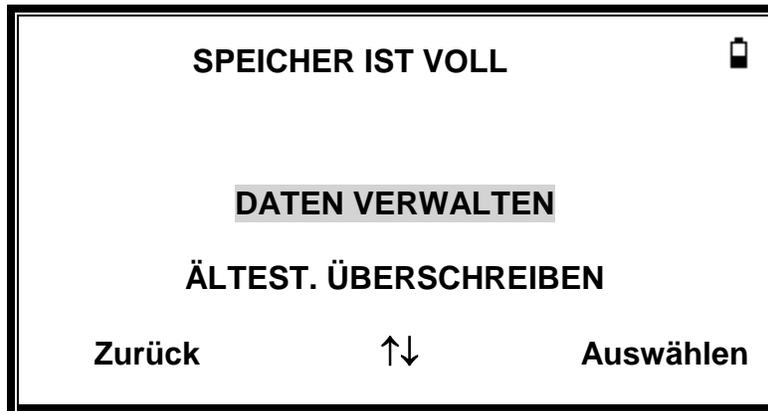
Nach Auswahl von DATEN VERWALTEN wird das Menü DATENVERWALTUNG angezeigt. Hier finden Sie Optionen zum Drucken und Übertragen von Daten an einen Computer. Anschließend können Sie Datensätze löschen, um Platz für einen neuen Test zu freizugeben.
