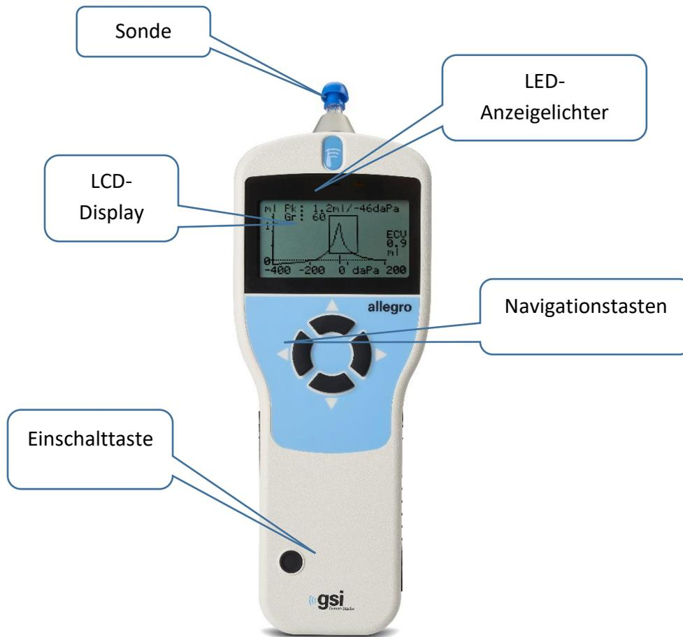
Durch kurzes Drücken der Einschalttaste wird das GSI Allegro eingeschaltet (siehe Abbildung weiter oben). Das Gerät braucht keine Aufwärmzeit, durchläuft jedoch wenige Sekunden lang eine kurze Diagnoseroutine. Während dieser Zeit läuft die interne Pumpe. Um das Gerät auszuschalten, drücken Sie die Einschalttaste erneut einige Sekunden lang.
