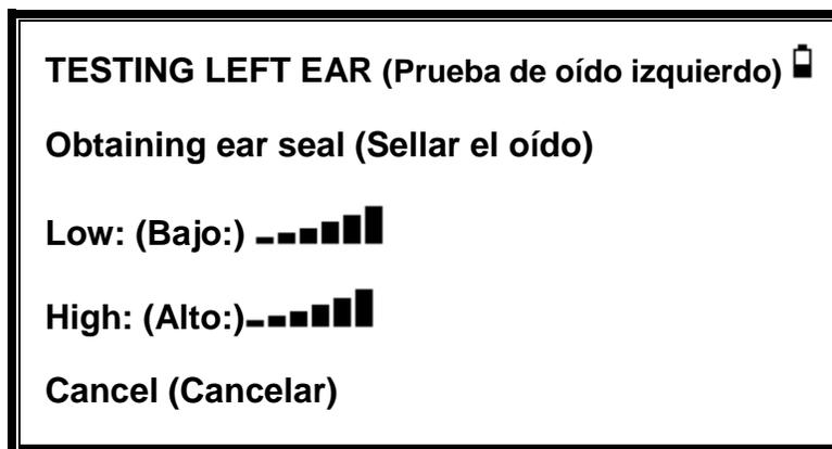
El número de barras mostradas indica la robustez del sellado del oído. La sonda debería ajustarse en el oído hasta que se muestren dos o más barras para Alto y Bajo.
